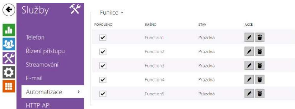
**2N LTE interkomy** poskytují velmi flexibilní možnosti nastavení dle různorodých požadavků uživatele. Existují situace, kdy běžný rozsah nastavení (např. nastavení chování spínačů nebo volání) nedostačuje, a pro tyto případy poskytuje **2N LTE interkomy** speciální programovatelné rozhraní **Automation**. Typické použití **Automation** je v aplikacích, které vyžadují složitější propojení se systémy třetích stran.
