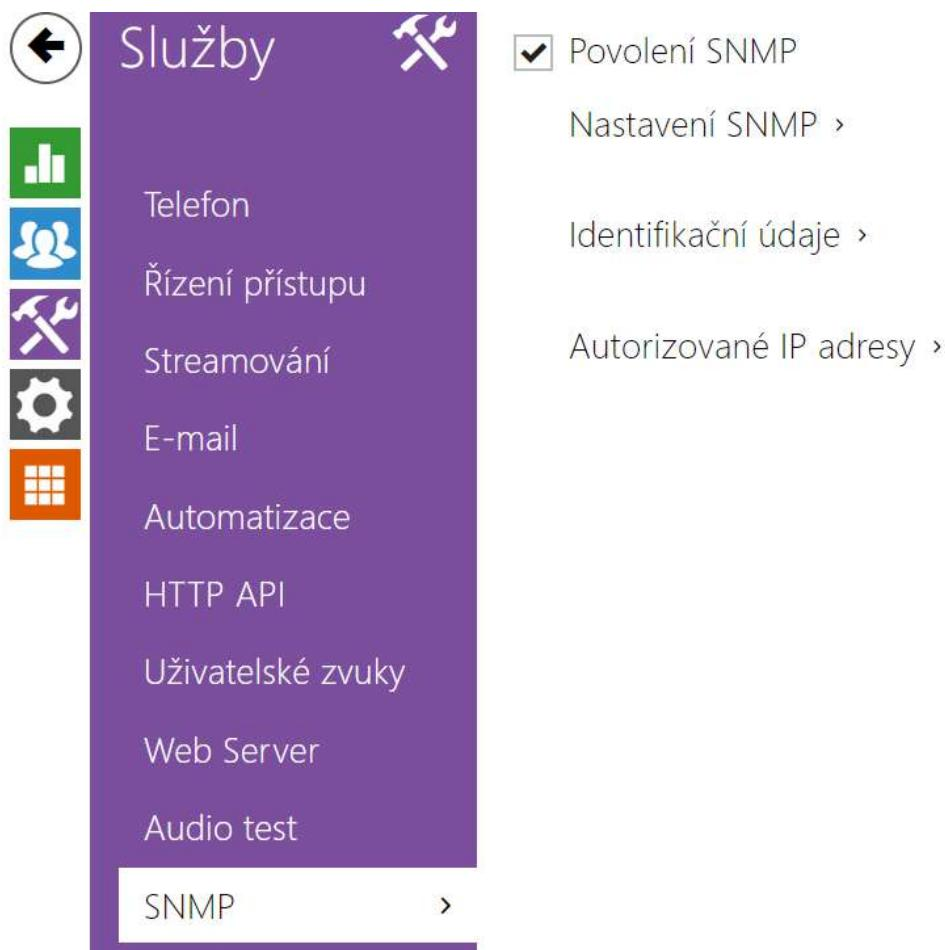
**2N LTE interkomy** integrují funkcionalitu umožňující vzdálený dohled interkomů v síti pomocí protokolu SNMP. SNMP agent integrovaný v zařízení je dostupný po vložení licenčního klíče s licencí **Enhanced Integration**. Interkomy podporují SNMP protokol verze 2c.
