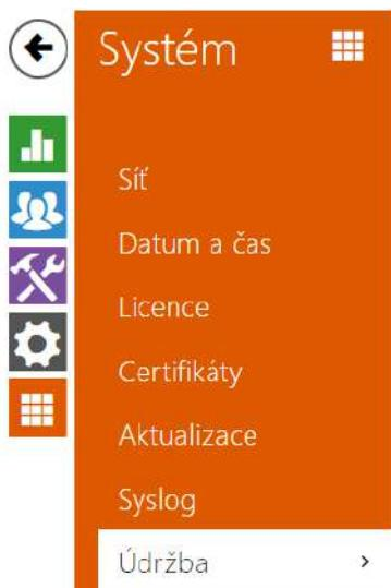
Toto menu slouží k údržbě konfigurace a firmwaru interkomu. Umožňuje zálohovat a obnovit nastavení všech parametrů, aktualizovat firmware interkomu příp. nastavit všechny parametry interkomu do výchozího stavu.
