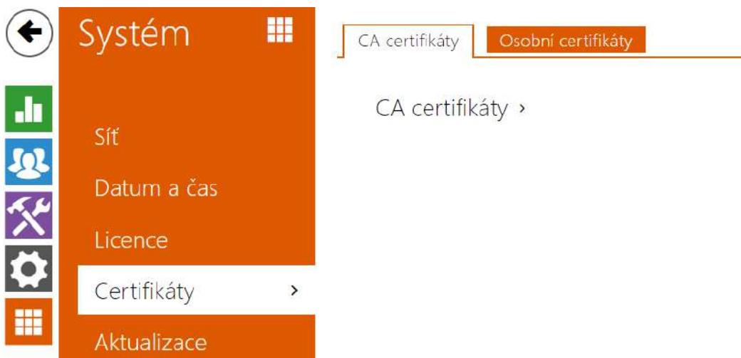
Některé síťové služby **2N LTE interkomu** využívají pro komunikaci s ostatními zařízeními v síti zabezpečený protokol TLS. Tento protokol zamezuje třetím stranám odposlouchávat příp. modifikovat obsah komunikace. Při navazování spojení pomocí TLS protokolu probíhá jednostranná příp. oboustranná autentizace, která vyžaduje certifikáty a privátní klíče.
