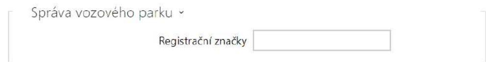
LTE IP interkom umožňuje využít rozpoznané registrační značky vozidel zaslané v HTTP požadavku kamerami od firmy AXIS vybavené doplňkovou aplikací VaxALPR na api/lpr/licenseplate (více [HTTP API manuál pro IP interkomy](#)).
