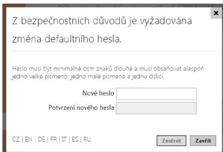
Zvolené heslo si dobře zapamatujte, příp. zapište. V případě, že heslo zapomenete, budete muset uvést interkom do výchozího stavu (viz instalační manuál k příslušnému modelu), a tím ztratíte zároveň veškeré provedené změny v nastavení.
