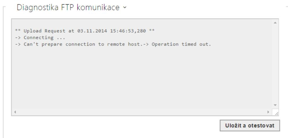
Po stisku tlačítka **Uložit a otestovat** dojde k uložení aktuálně nastavené konfigurace FTP serveru, sejmout obrázku z kamery a jeho uložení na FTP server. V průběhu ukládání obrázku se v okně výše zobrazuje detailní průběh komunikace s FTP serverem.
