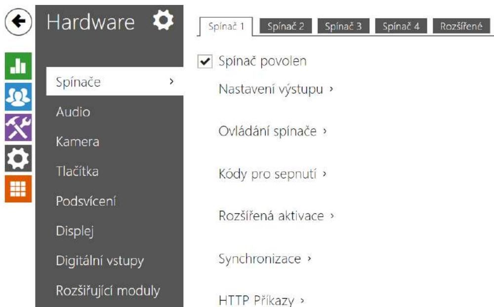
Spínače umožňují velmi flexibilní řízení různých periferií připojených k interkomu (jako jsou elektrické dveřní zámky, osvětlení, doplňková signalizace zvonění apod.).
