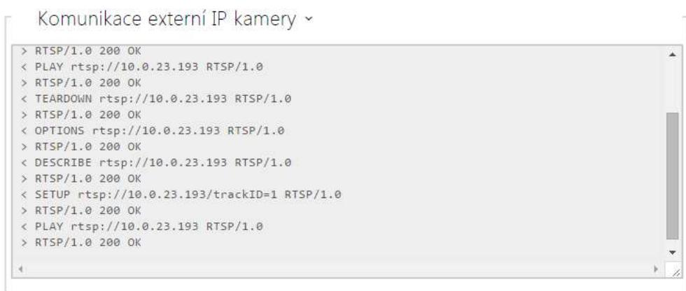
V okně Komunikace externí IP kamery se zobrazuje průběh RTSP komunikace s nastavenou externí IP kamerou včetně případných chyb a poruchových stavů.
