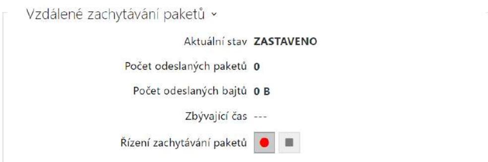
Vzdálené zachytávání můžete spustit pomocí tlačítka  . Je potřeba upřesnit čas (s), během kterého se příchozí a odchozí pakety mají zachytávat. Po uplynutí nastavené časové hodnoty bude soubor se zachycenými pakety automaticky stažen do PC uživatele. Zastavit zachytávání lze pomocí tlačítka  .
