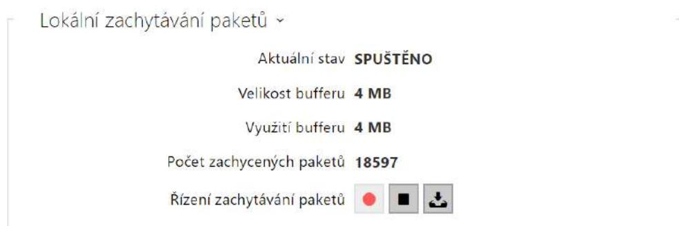
Po zaplnění bufferu při lokálním zachytávání dochází automaticky k přepisu nejstarších uložených paketů. Při lokálním zachytávání paketů doporučujeme snížit přenosovou rychlosť video streamu pod hodnotu 512 kbps. Zachytávání můžete spustit pomocí tlačítka , zastavit pomocí tlačítka  a soubor se zachycenými pakety stáhnout pomocí tlačítka .
