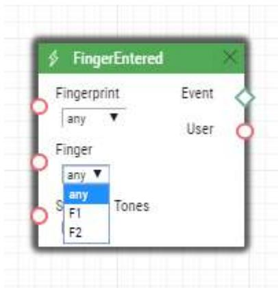
Po nastavení otisků prstů a jejich funkcí proces potvrďte kliknutím na ULOŽIT A ZAVŘÍT.
