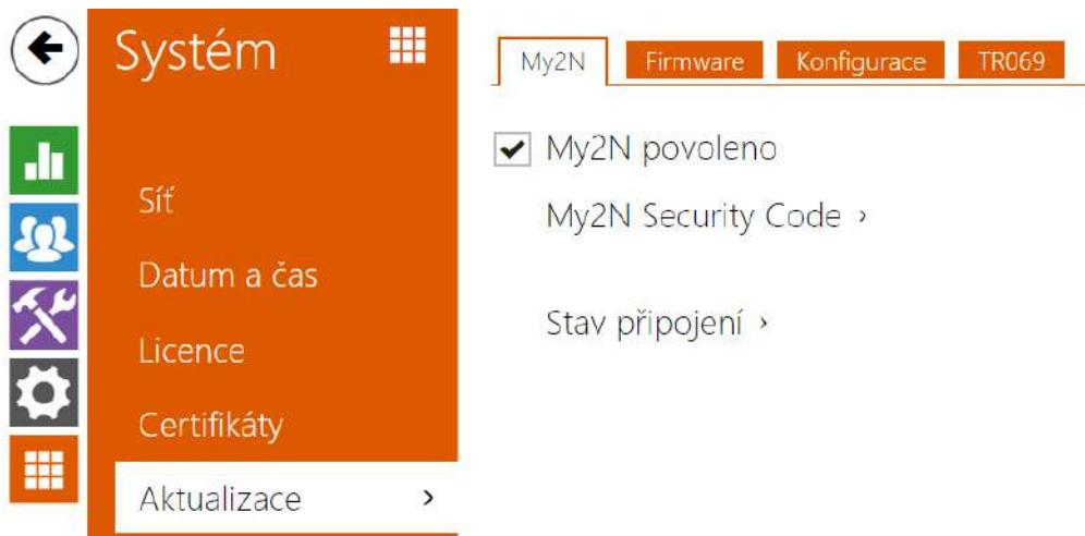
**2N LTE interkomy** umožňují kromě manuální aktualizace firmware a konfigurace také automaticky stahovat a aktualizovat firmware a konfiguraci podle stanovených pravidel z úložiště na vámi definovaném TFTP nebo HTTP serveru.
