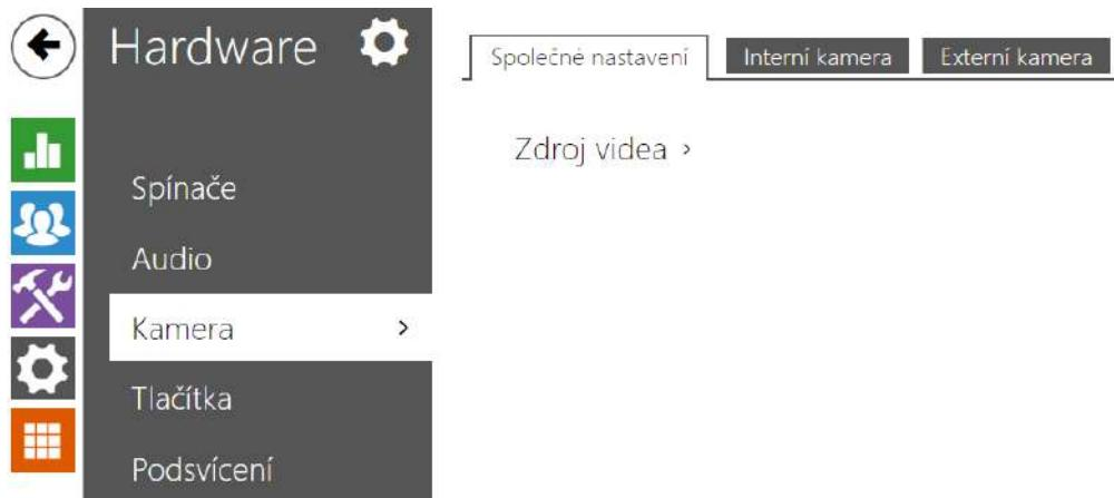
Toto menu je dostupné pouze u **2N LTE interkomů**, které jsou vybaveny interní kamerou nebo umožňují připojit externí kameru. Signál z kamery lze streamovat přímo do hovoru na video telefon, odesílat pomocí e-mailů, streamovat pomocí ONVIF/RTSP protokolu na jiné zařízení (např. video surveillance) nebo jednoduše stahovat z interkomu jako JPEG snímky pomocí HTTP protokolu.
