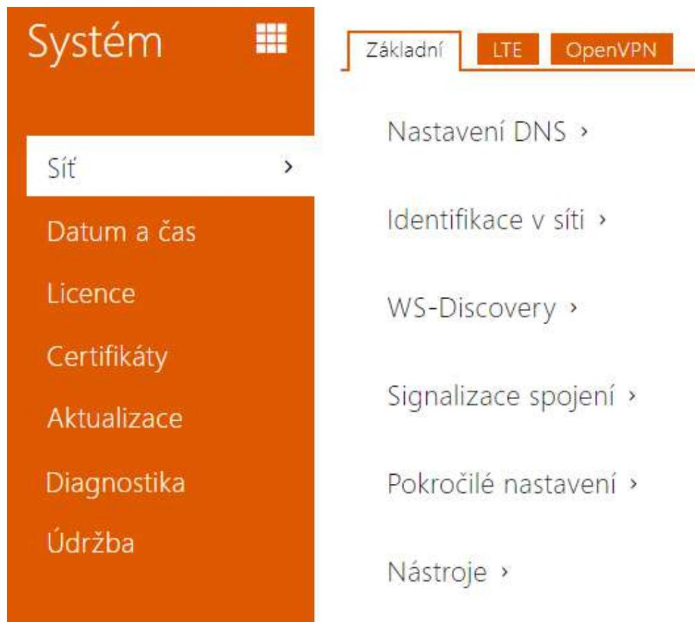
**2N LTE interkom** se připojuje přes SIM kartu do mobilní datové sítě LTE. Nastavení přístupových údajů (APN, přístupového jména a hesla) proběhne automaticky. Pokud potřebujete nastavení přístupových údajů do mobilní datové sítě změnit, je to možné pomocí SMS (viz instalacní manuál) nebo v záložce LTE webového konfiguračního rozhraní (popsáno níže).
