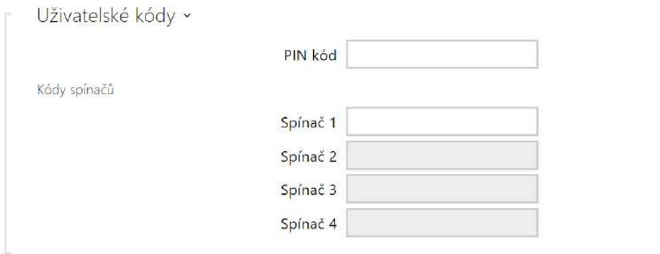
Každý z uživatelů může mít přiřazen vlastní soukromý kód pro sepnutí spínače. Uživatelské kódy spínačů lze libovolně kombinovat s univerzálními kódy spínačů zadanými v menu **Hardware / Spínače**. Pokud se kódy překrývají s jinými kódy již zadanými v konfiguraci interkomu, pak se u takto kolidujících kódů objeví značka **!**.
