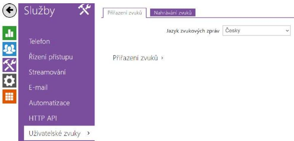
**2N LTE interkomy** standardně signalizují různé provozní stavů pomocí sekvencí tónů, viz kapitola Signalizace provozních stavů. Pokud vašim požadavkům standardní signalizační tóny nevyhovují, můžete je upravit.
